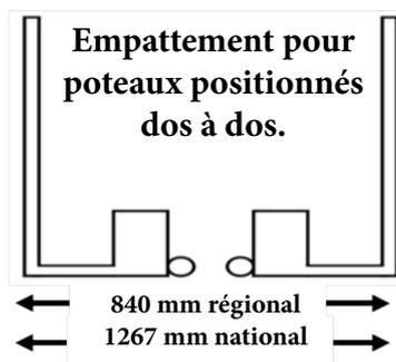
Conformes à la norme NF EN 1509 et aux recommandations de la FFBA
