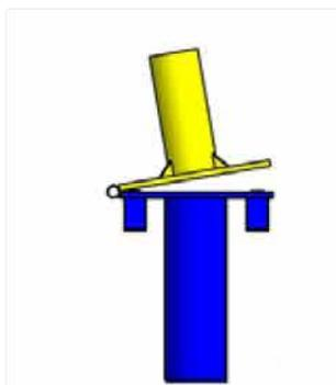
4120 Le jeu de 4 platines de basculement avec charnières. Facilite la pose et la dépose des poteaux.
